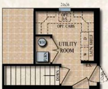
OPTIONAL BASEMENT STAIRWELL
